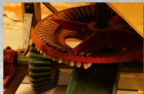
*Vue générale de la galerie et vue en détail de l'engrenage entraînant la meule et de son astucieux remplacement des dents usées qui sont en bois et ne réclament d'autre outil qu'un bon couteau pour les tailler.*
